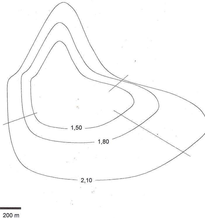
4. En el plano de curvas de nivel que se presenta calcule: a) el sentido de la pendiente ascendente (hay que colocar una flecha b) ¿qué forma del paisaje está representando esta figura?, c) descomponga y calcule las pendientes de cada transecta, d) si tuviera que nivelar para riego por surcos ¿esta sería una zona de acumulación o de extracción de suelo? Explique.
