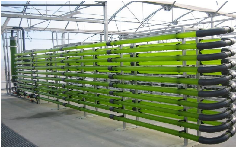
Figura 5.5: Fotobiorreactor horizontal tubular. Fuente: López González (2016)
