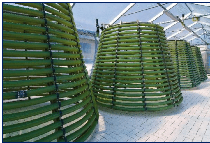
Figura 5.6: Fotobiorreactor de tipo helicoidal. Fuente: Acuña Torres (2008)
