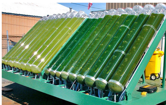
Figura 5.3: Fotobiorreactor vertical tubular. Fuente: Núñez Rivera (2017)
