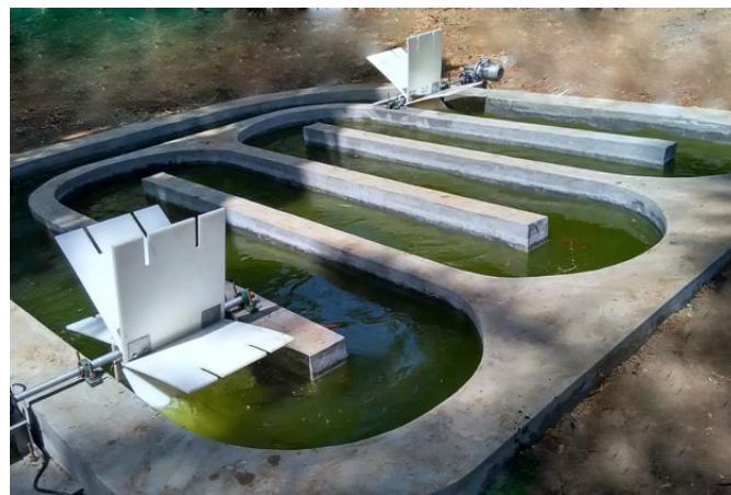
Figura 5.2: Cultivo raceway. Fuente: Ozone (2017)
