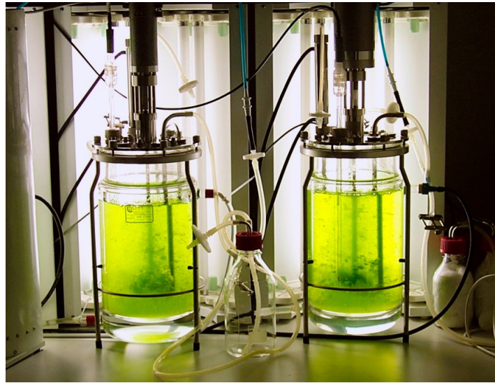
Figura 5.7: Fotobiorreactor de tanque agitado. Fuente: String Fixer (2020)
