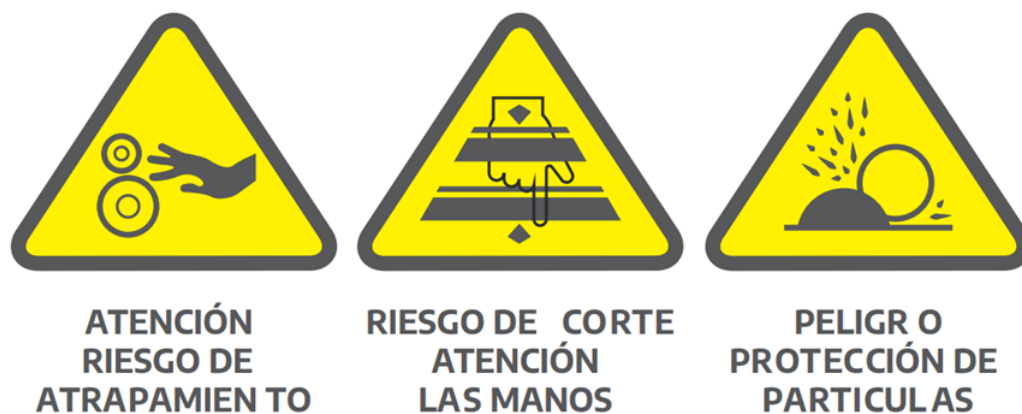
Figura 7.1: Riesgos Mecánicos. Extraído de Dirección de Seguridad Laboral (2013)
