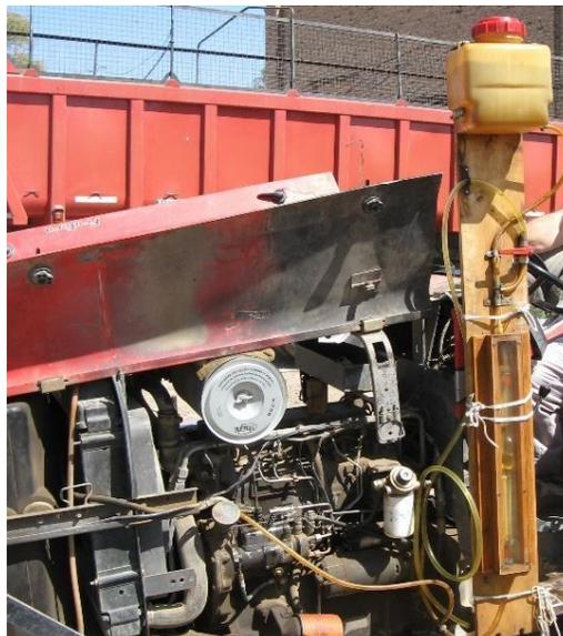
Fig. 26: Dispositivo para medir consumo de combustible
