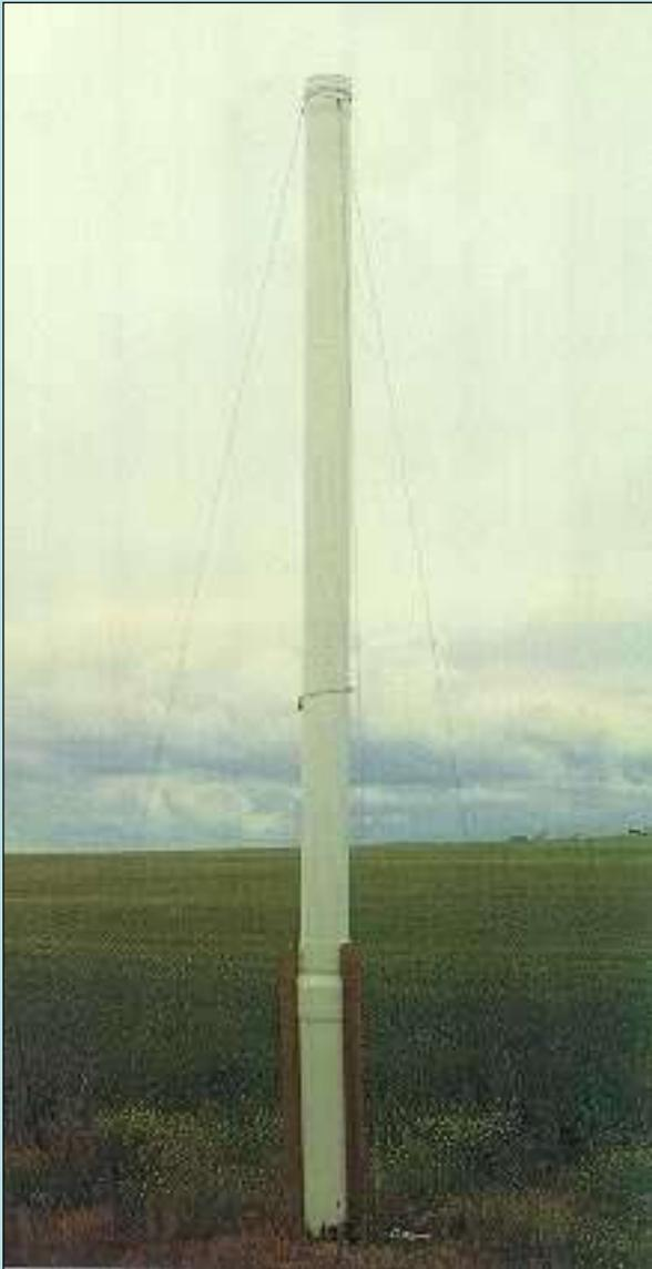
Distintos tipos que tienen en común la existencia de un sistema de aspiración, de un tubo colector y de un sistema de filtración para áfidos alados
