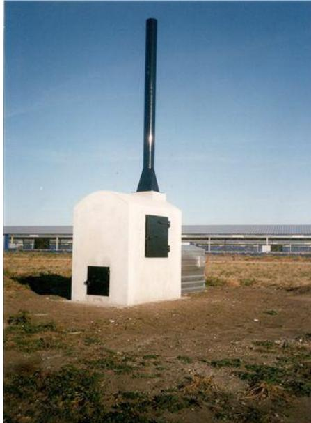
Figura 14. Horno incinerador (Fotografía gentileza Dr. Héctor Arbiza).
