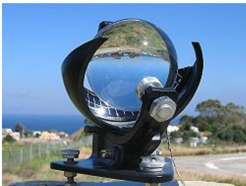
Este modelo se basa en una esfera de cristal (típicamente de 10 cm de diámetro) que concentra los rayos solares sobre una banda de cartulina de forma tal que, al quemarse, deja una traza carbonizada. La esfera está montada concéntricamente dentro de un [casquete esférico](#) de metal, sobre cuya superficie interior, y sujeta por medio de unas ranuras especiales, se coloca la banda de cartulina. De esta forma, la cartulina se
