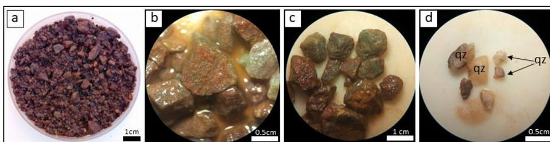
**Figura 22.** a), b) y c) Fotografías con lupa binocular del cutting del sondaje AGI-92. d) Fragmentos angulosos de cuarzo.
