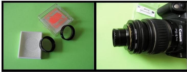
Figura 1. Red de Difracción y cámara DLSR
