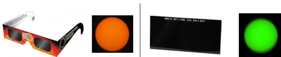
Figura 7: Métodos seguros para observar el eclipse solar en forma directa: anteojos para eclipses (el Sol se observa naranja) y filtro de máscara de soldar (el Sol se observa verde).
