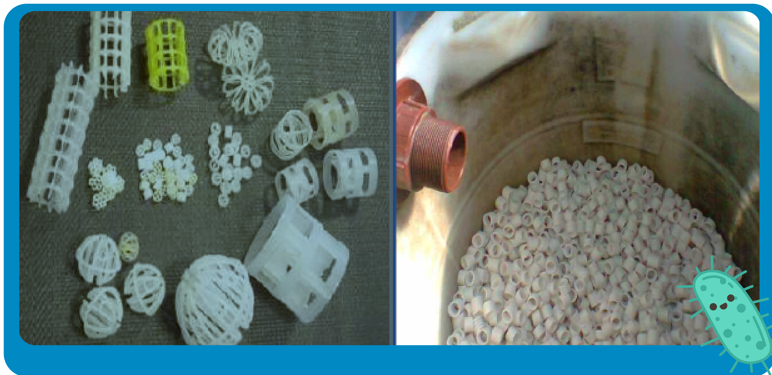
Diversos materiales inertes para biofiltros - CENADAC
