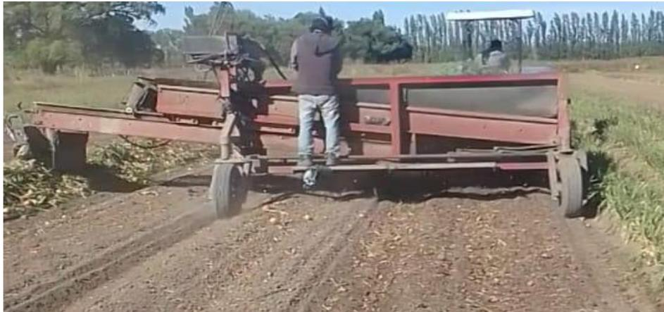
**Figura 2.** Vista posterior de la arrancadora apilando la cebolla.
