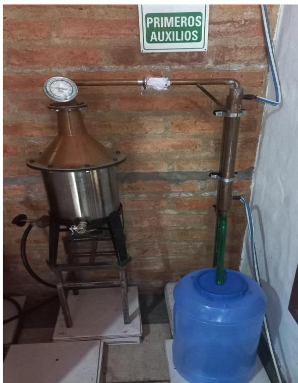
*Imagen N° 4: Alambique junto a fermentador donde se produce el proceso de Destilación*
