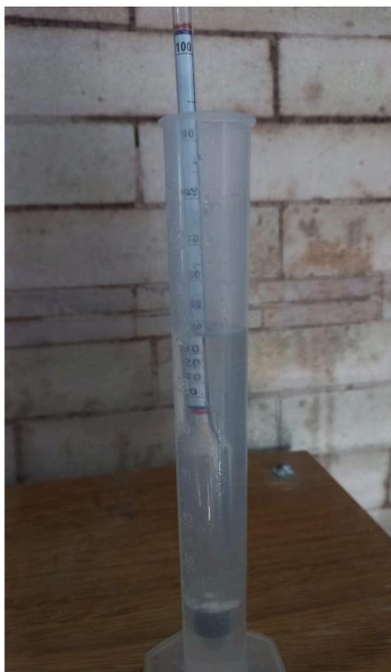
*Imagen N° 7: Recipiente del alcoholímetro. Demostración de cómo se calcula el porcentaje de alcohol*
