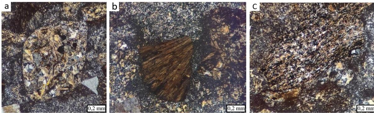
Figura 19: Cortes delgados en nicoles cruzados de arenisca identificada en la finalización del P4: a: lítico de roca volcánica andesítica, b: arreglo de minerales fibrosos que determinan una morfología en abanico; c: lítico metamórfico.
