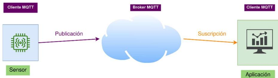
Figura 4. Diagrama de la arquitectura de comunicación
