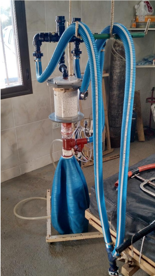
Imagen 2. Equipo de sistema inhalatorio con un circuito semicerrado.
