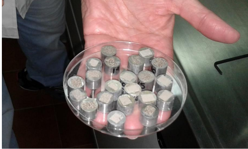
Figura II-11: Muestras montadas en Specimen Mount, \phi 12.2 \times 10 mm.
