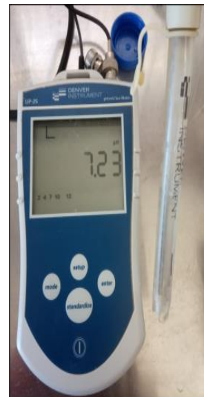
Figura II-7: Conductímetro Denver Instrument Up-25 pH/mV/Ion Meter siendo calibrado para inicial medición en la tercera campaña.
