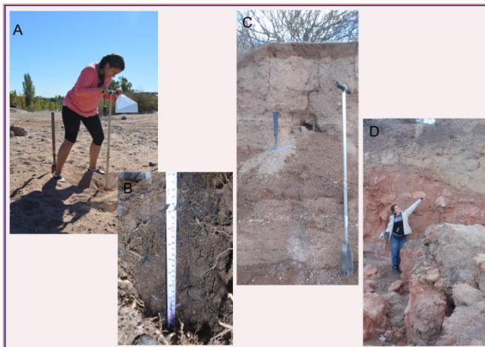
Figura II-9: Equipos de muestreos de suelos y sedimentos. A. Muestreo con barreno Eijkelkamp y pala en meandro abandonado. B. Cinta métrica en pozo de barreno. C. Observación y relevamiento de terraza donde se observa barreno Eijkelkamp y piqueta. D. Momento de descripción geomorfológica y sedimentológica de terraza.
