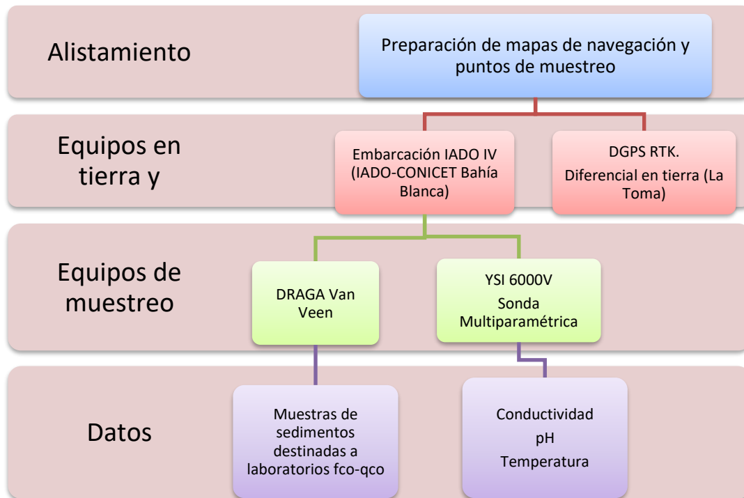
Figura II-3: Esquema metodológico de campaña de campo para la obtención de datos de sedimentos transportados en el estuario del río Negro.
