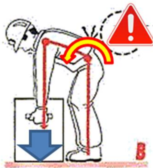
Imagen 14: Momento flexor por carga desplazada. Fuente: Adaptada de (González, 2009)
