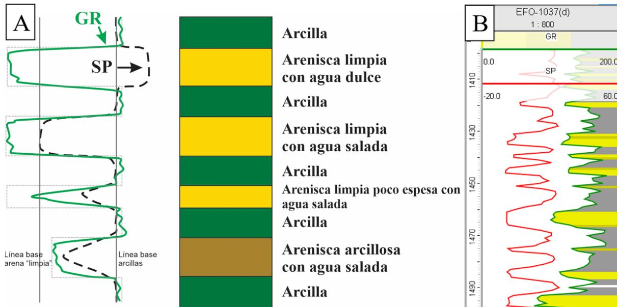
Figura 20. A) Ejemplo de las respuestas de las herramientas de GR y SP frente a diferentes litologías (Modificado de Casadío y Montagna, 2015). B) Ejemplo de registro real de GR y SP donde se observa su respuesta frente a areniscas y arcillas.
