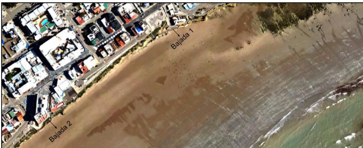
Fig. 3.37. Vista aérea de la Sección 4 tomada con VANT. Es posible destacar la surgencia de agua desde la playa.
