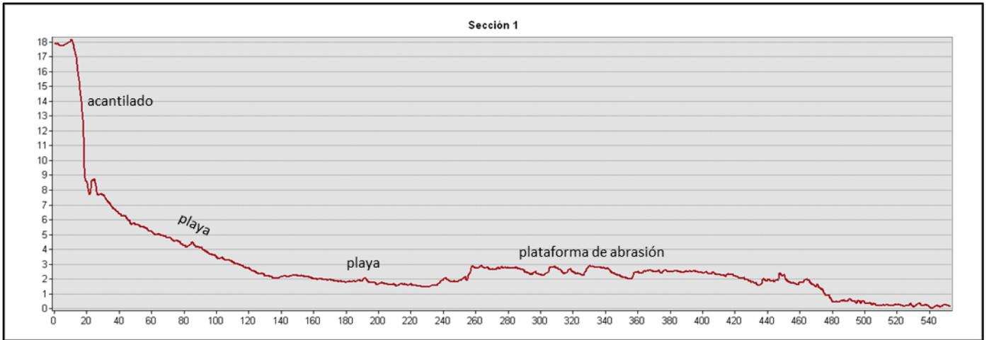
Fig. 3.21. Perfil topográfico tipo de la sección, perpendicular a la línea de costa, desde la cresta del acantilado hasta la zona de rompiente de olas, obtenido a partir del MDE. Es posible destacar las elevaciones correspondientes a la plataforma de abrasión. Las unidades de ambos ejes son metros.
