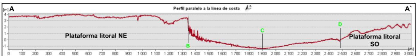
Fig. 3.12. Perfil topográfico paralelo a la línea de costa, obtenido a partir del MDE generado mediante los vuelos con VANT. A: "La Rinconada; A': Bajada 5.
