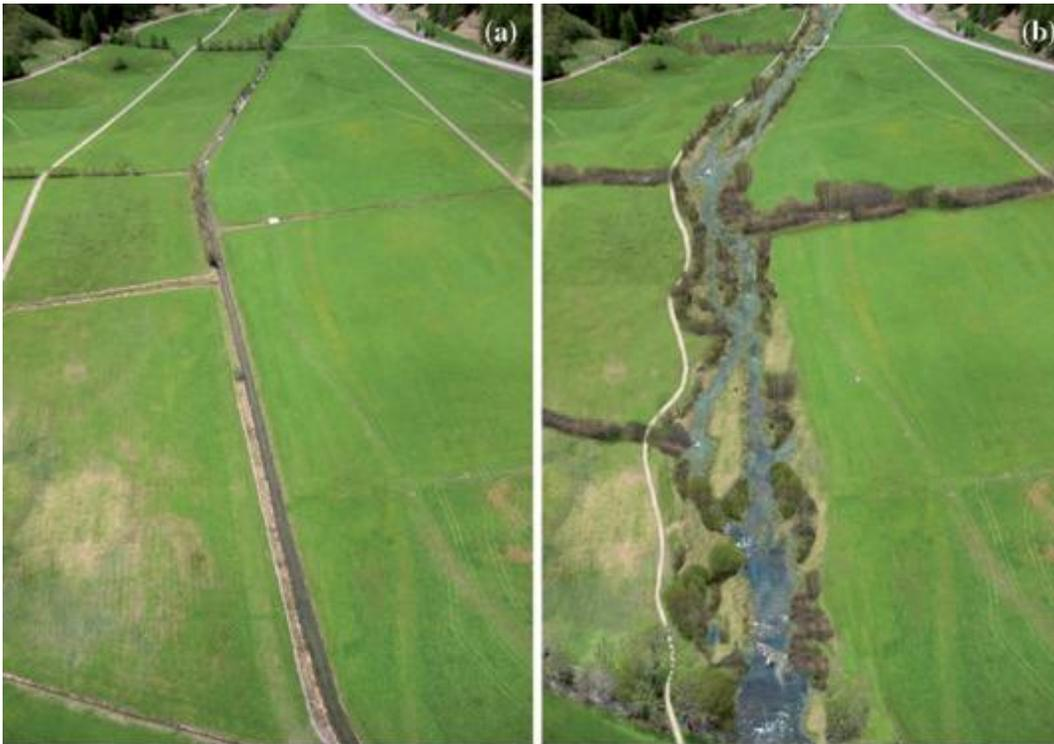
Figura 21. Canalización (a) y posterior restauración (b) del río Rombach en Fuldera. Fuente: Pio Pitsch
