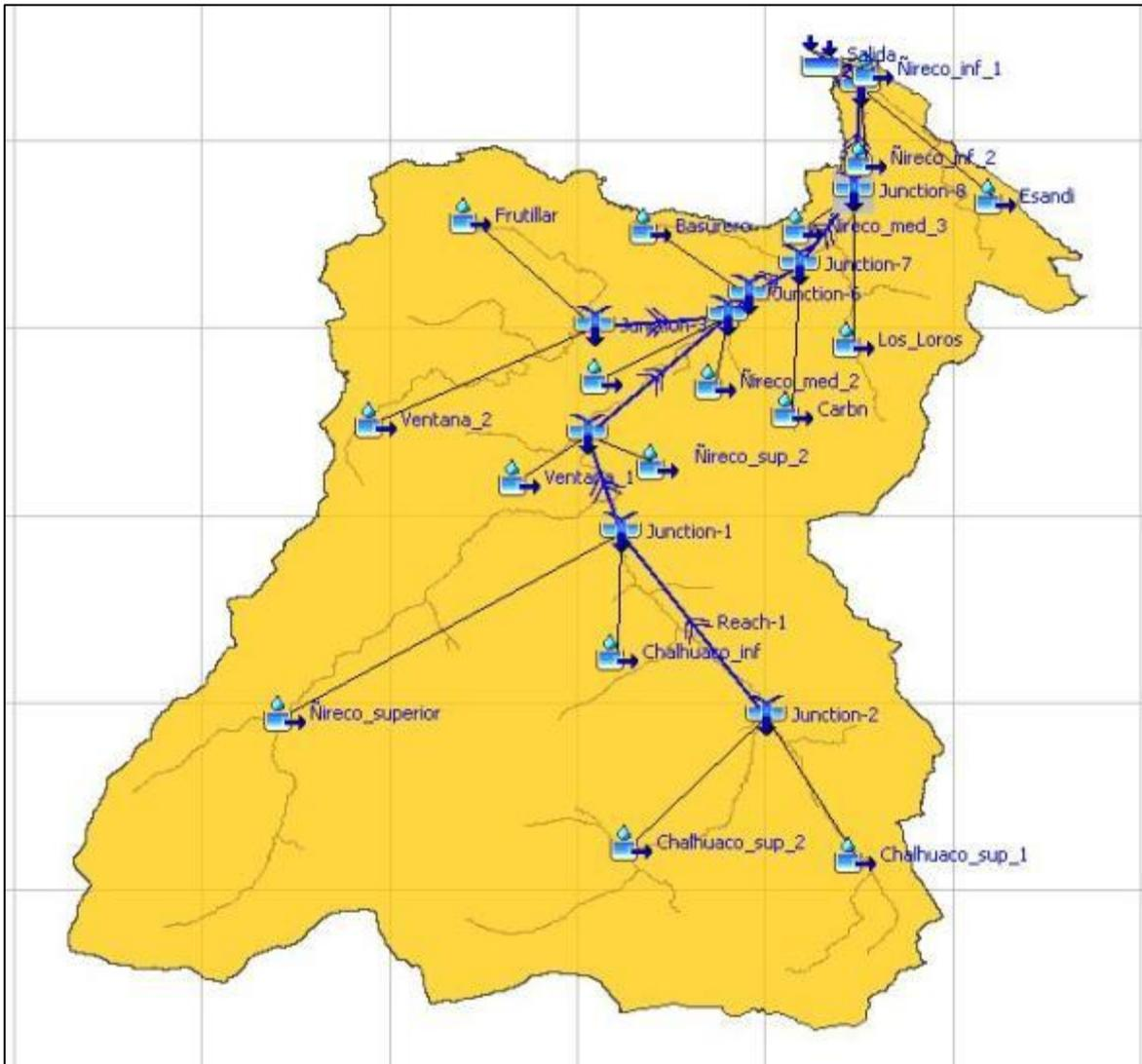
Figura 59. Esquema topológico de la cuenca del arroyo Ñireco en HEC-HMS. Fuente: Elaboración propia.
