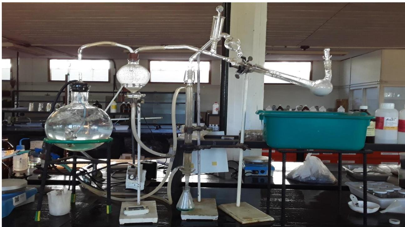
*Figura 15 – Destilador para determinación de N inorgánico, Amonio y Nitrato - Laboratorio de suelos (EEA INTA Bariloche).*
