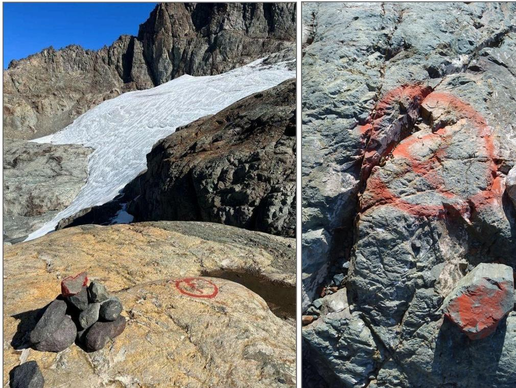
Figura 7.11: punto fotográfico y punto fijo de referencia utilizados en monitoreo (fuente propia, 2023).
