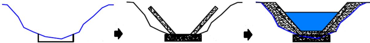
*Figura 8.4:* esquema de etapas para el revestimiento de un canal con hormigón (*DPA, 2022b*).
