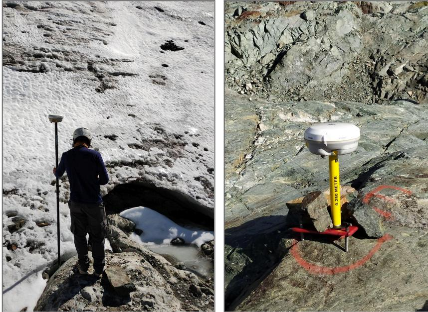
*Figura 7.12:* uso de GPS diferencial de doble frecuencia (fuente propia, 2023).
