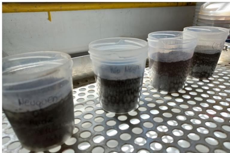
**Figura 12.** Determinación de CC en muestras de suelo.
