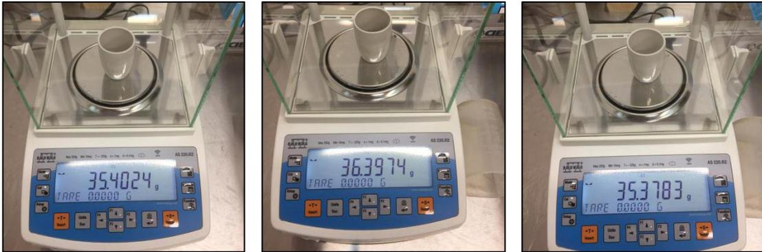
Figura 21: Determinación de densidad aparente de pellets de fuste (izquierda), ramas (medio) y follaje (derecha)
