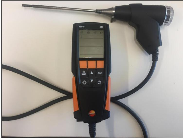
Figura 30: Muestreador isocinético de gases (izquierda) y consola de medición (derecha)
