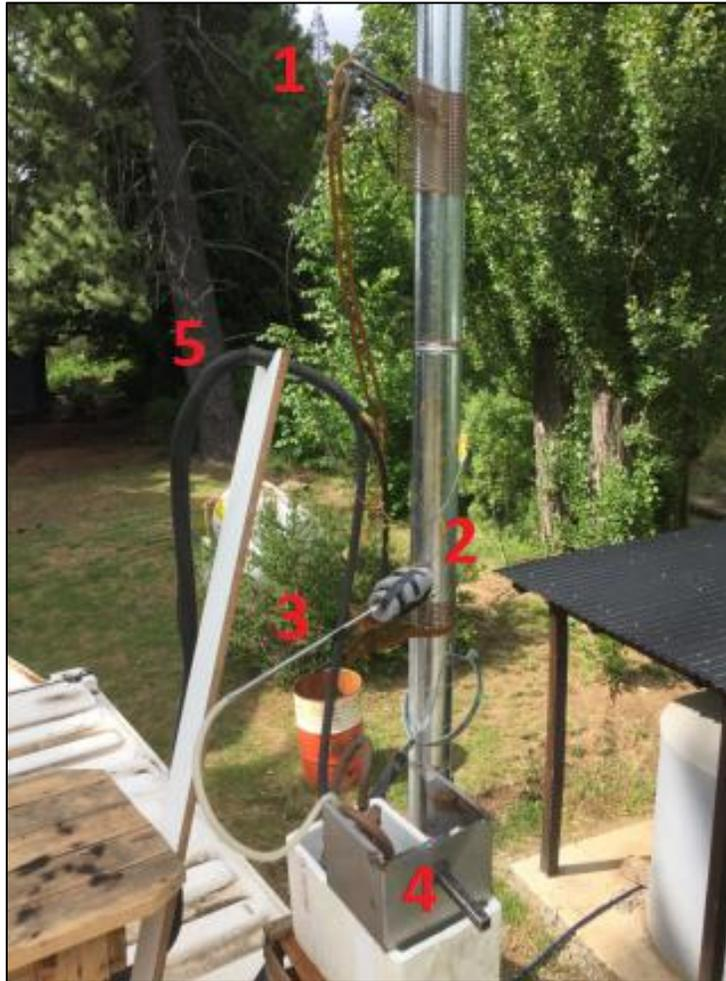
Figura 29: Analizador de gases de combustión Testo 310
