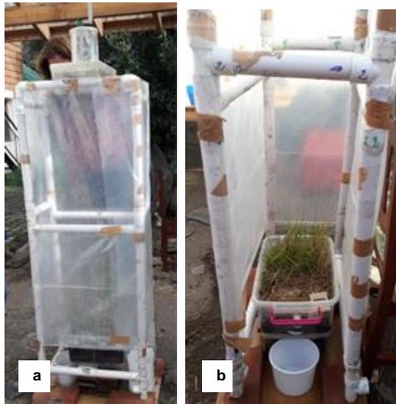
**Figura 12:** (a) Aspecto del simulador de lluvia sobre las microparcels de hidrosiembra. (b) microparcela de hidrosiembra con geotextil de coco en el simulador de lluvia. Fuente: propia.
