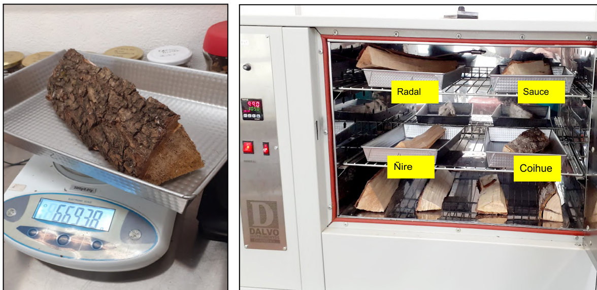
Imagen 11: Determinación de humedad mediante estufa.
