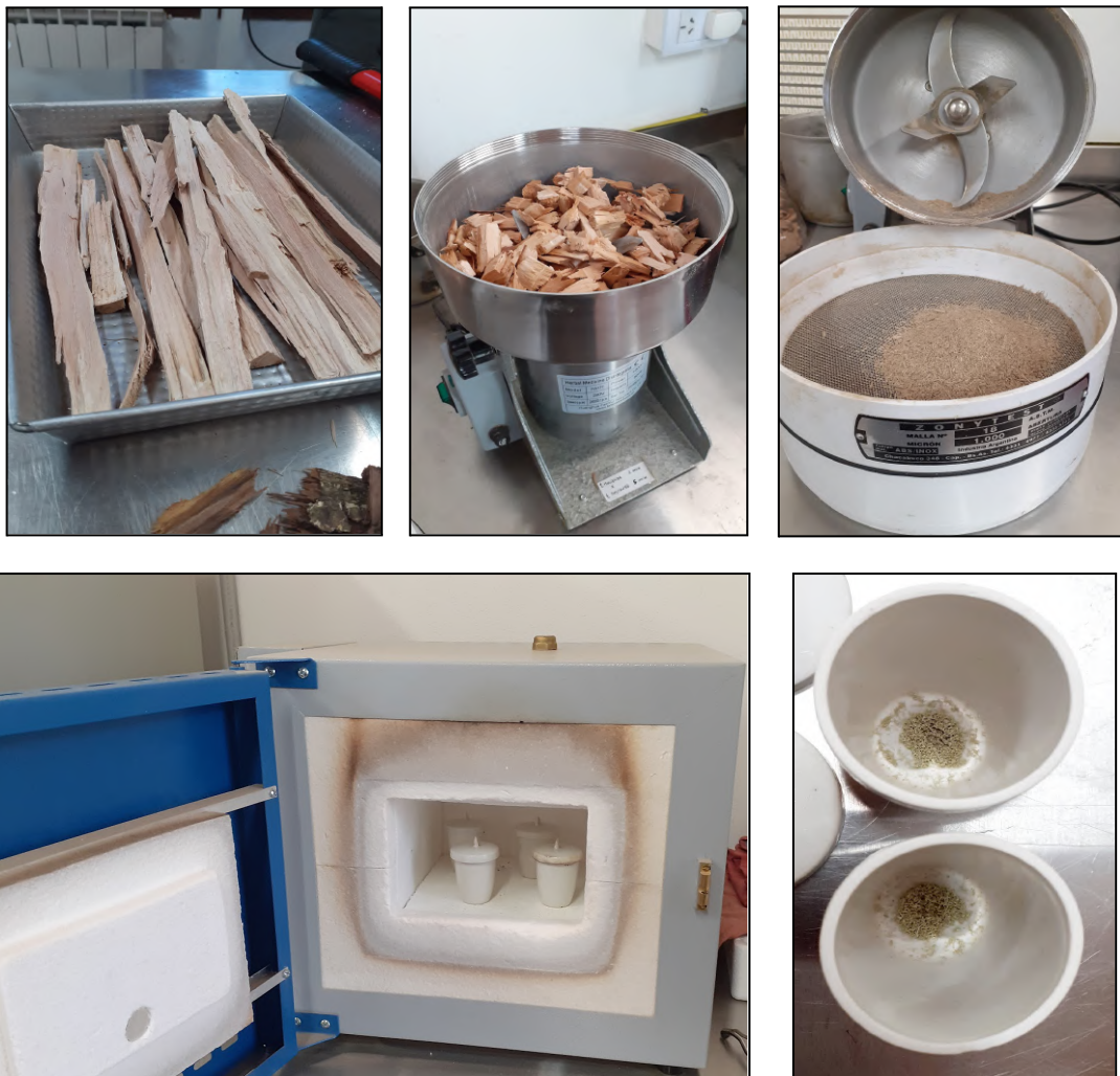
Imagen 13: Determinación de contenido de cenizas. Molienda, tamizado y calcinado en mufla del material leñoso.
