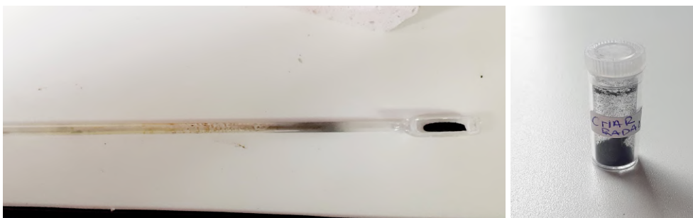
Imagen 19: Char obtenido luego de la pirólisis.
