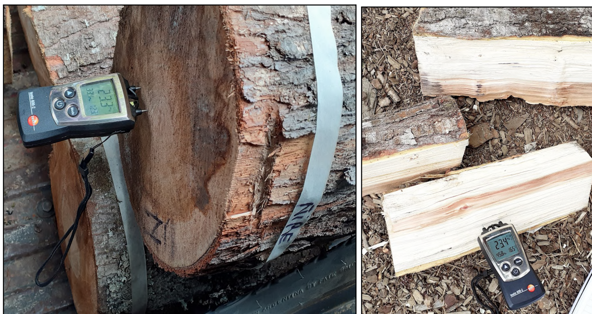
Imagen 10: Determinación de humedad por xilohigrómetro.
