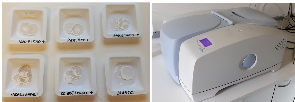
Imagen 15: Pastillas de BrK y con las muestras a analizar. Espectrofotómetro FT-NIR Perkin Elmer Spectrum400.
