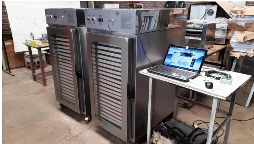
Figura 29 : Horno secador marca BYRD modelo H20.
