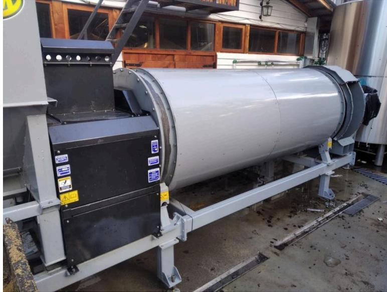
Figura 33 Prototipo de secador de bagazo instalado en la fábrica de Wesley.
