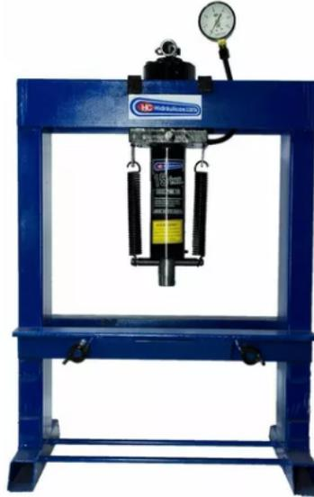
Figura 27 Prensa hidráulica 15 toneladas <sup>61</sup>.
