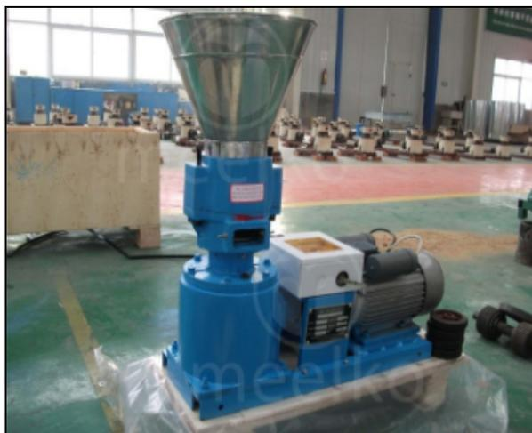
Figura 43 Pelletizadora modelo MKFD230C, 100/120 kg/hora <sup>75</sup>.
