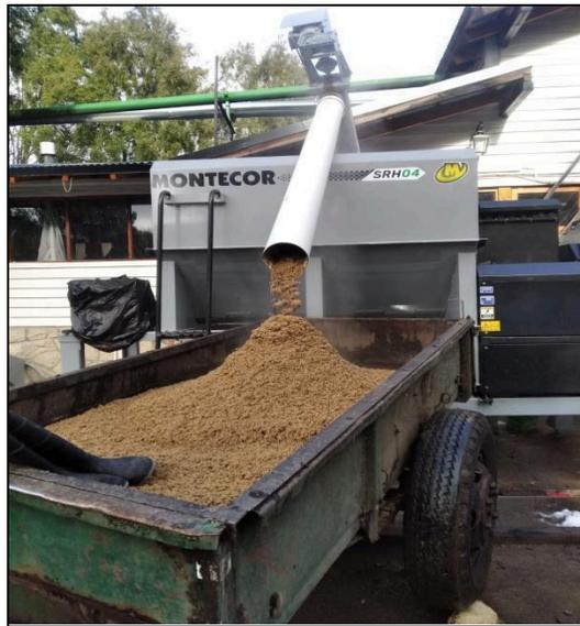
Figura 35 Vista de frente del secador mientras se carga el bagazo en un remolque.
