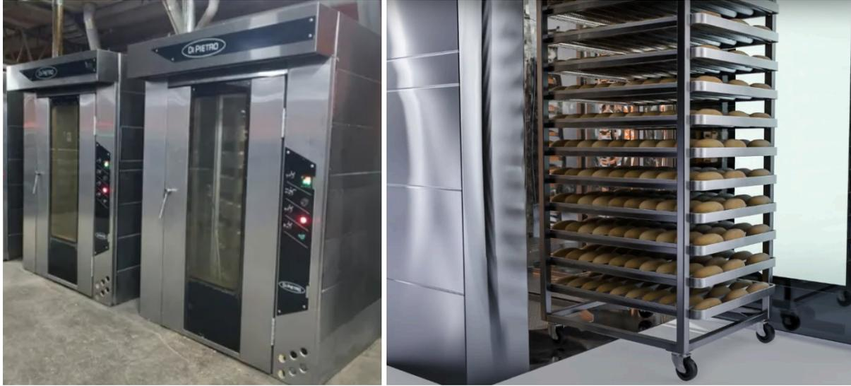
Figura 28 Horno rotativo convectivo marca “Di Pietro” <sup>62</sup>.
