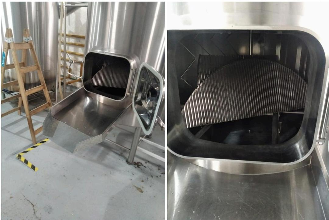
Figura 10 Foto de un macerador con falso fondo.
