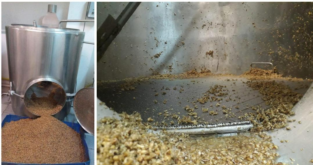
Figura 11 Retiro de bagazo de un macerador una vez finalizado el lavado del grano.
