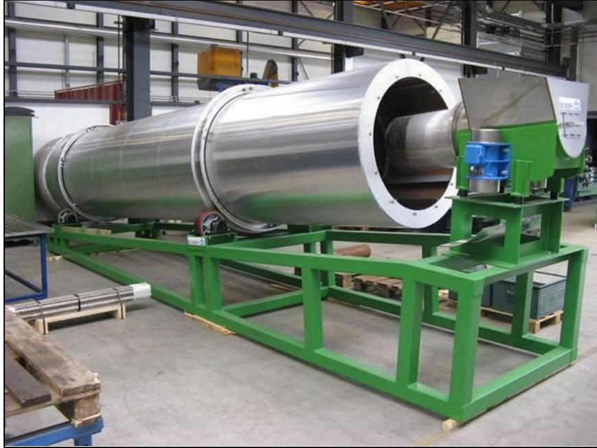
Figura 32 Secador industrial <sup>65</sup>.
