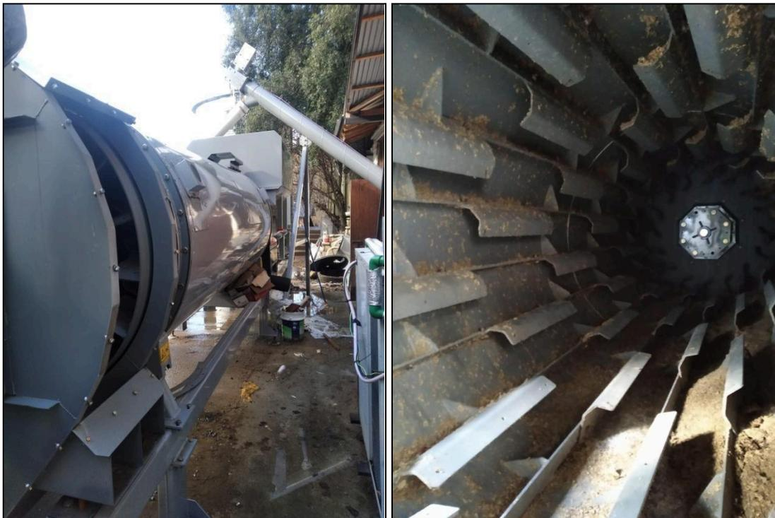
Figura 34 Vista lateral e interna del secador de bagazo.
