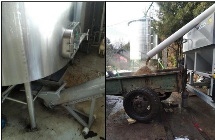
Figura 22 Salida del macerador y carga del vehículo para ser transportado.
