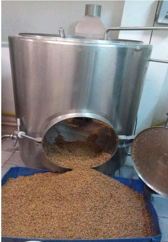
Figura 18 Recipientes para extracción de bagazo.
