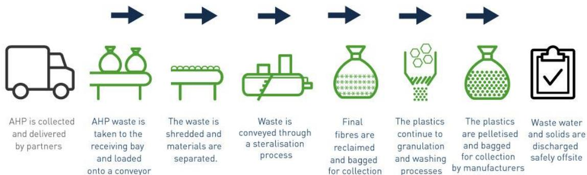
Figura 4.1: proceso desarrollado por la empresa Knowaste. Recuperado de “*Knowaste submits plan for UK’s largest AHP recycling facility*”, de Faulker, G., 2015. Recuperado de: <http://www.recyclingwasteworld.co.uk/news/knowaste-submits-plans-for-uks-largest-ahp-recycling-facility-1/99189/>
