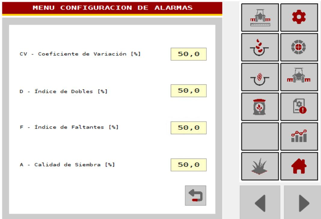
Figura 35: Pantalla de configuración de alarmas ejecutando desde la ECU, visualizada en el simulador.
