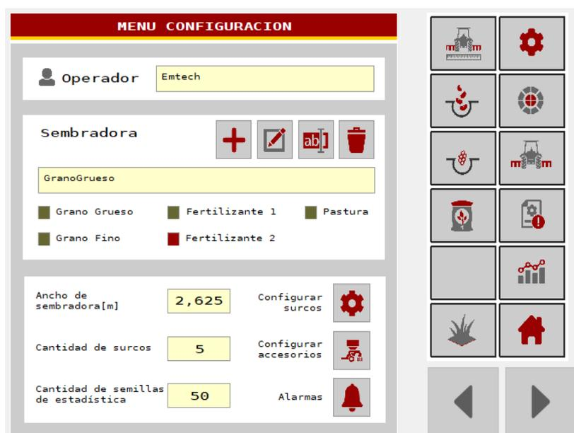
Figura 24: Pantalla de configuración ejecutando desde la ECU, visualizada en el simulador.
