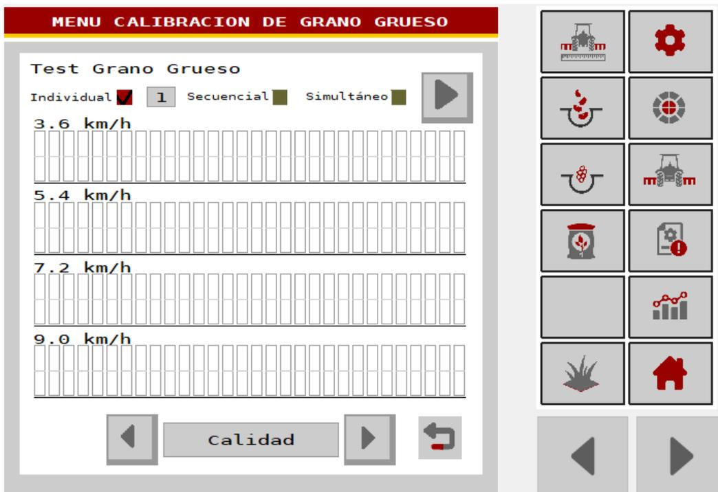
Figura 38: Pantalla de Calibración de grano grueso ejecutando desde la ECU, visualizada en el simulador.
