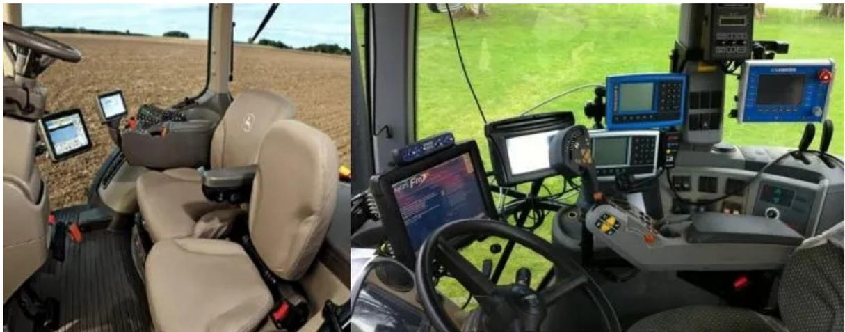
*Figura 1: Izquierda: Interior de tractor con Monitor ISOBUS. Derecha: Interior de tractor con múltiples pantallas.*
