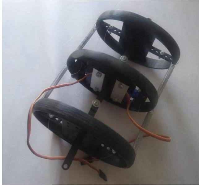
**Figura 18** Módulo de acción con las piezas impresas en 3D con los servomotores instalados asegurados por las chapas metálicas y con los resortes colocados en los laterales.
