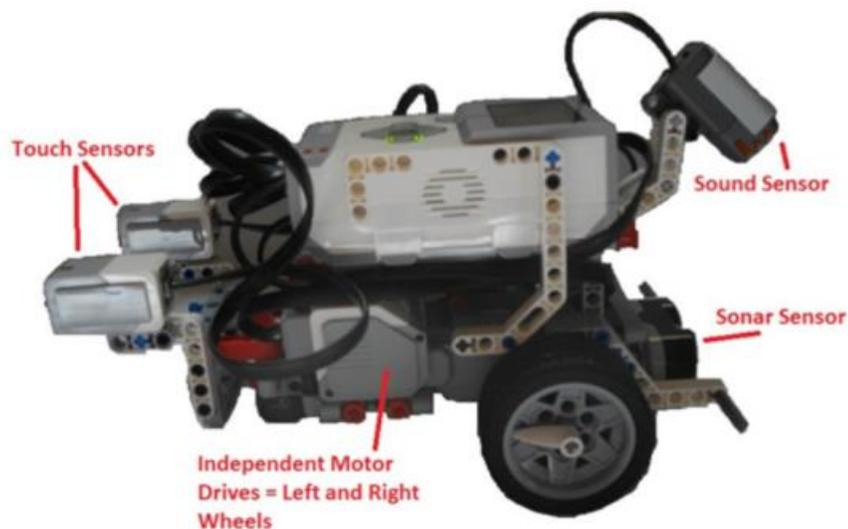
*Figura 6 Robot Lego Mindstorms EV3. Touch Sensors (Sensores de tacto), Sound Sensor (sensor de sonido), Sonar Sensor (Sensor Sonar), Independent Motor (Motor Independiente), Drives = Left and Right (Maneja = Izquierda y Derecha), Wheels (Ruedas) (Busbice, May 22, 2014).*
