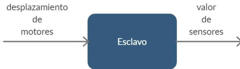
**Figura 22** Flujo de información que maneja el esclavo. Recibe el desplazamiento de los motores del maestro y le devuelve al maestro el valor de los sensores.
