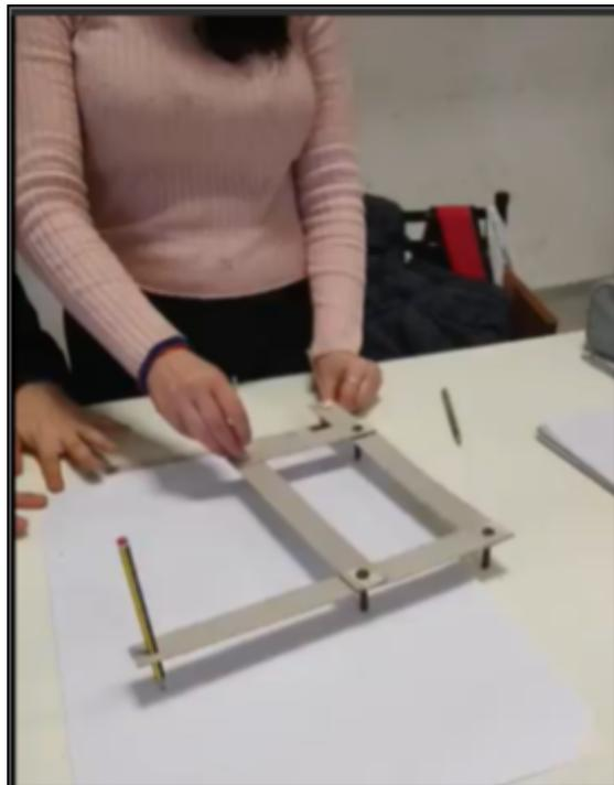
Imagen 7. Estudiante usando el pantógrafo para copiar un triángulo. Fotografía propia.
