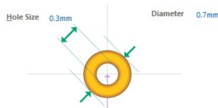
**Figura 4.4.:** Ejemplificación de diseño de tamaño de vías
