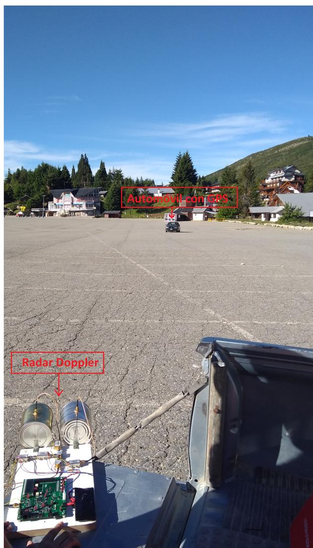
Figura 6.9.: Calibración en campo
