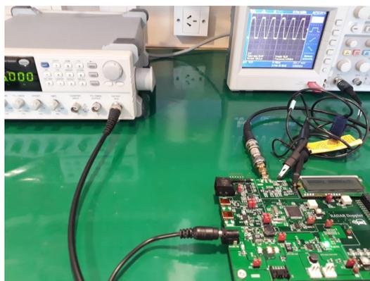
**Figura 6.2.:** Set up utilizado para medir la transferencia del filtro
