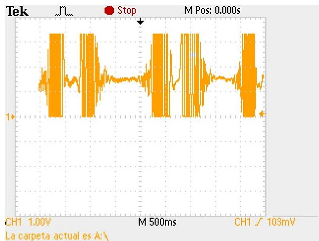
**Figura 6.4.:** Señal obtenida en punto de medición 9 (señal Doppler)
