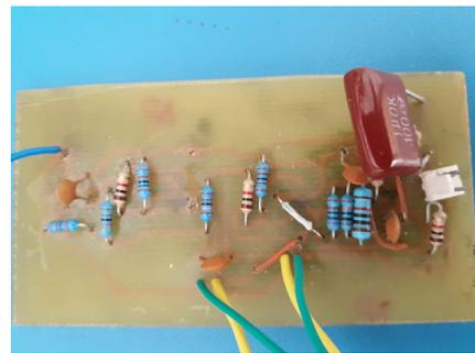
**Figura 4.15.:** Diseño PCB del Prototipo LPF, componentes
