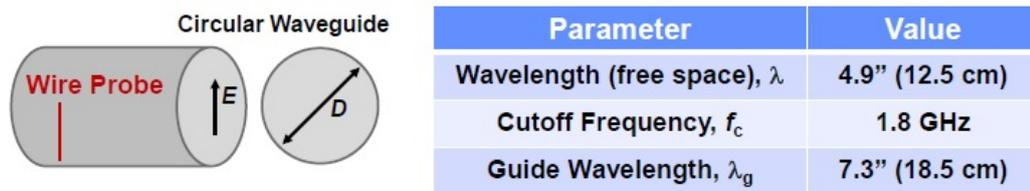
**Figura 2.31.:** Ejemplo: Guía de onda circular (latas de durazno), diámetro: 9.9cm , frecuencia = 2,4 GHz
