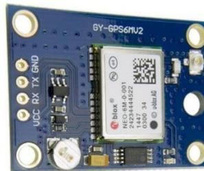
**Figura 2:** Módulo GPS NEO6M/V.
