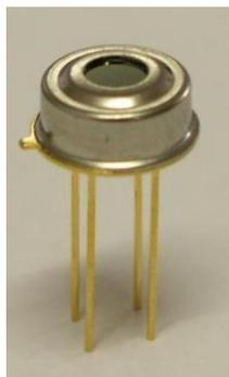
***Figura 8:** Sensor de temperatura MLX90614B.*
