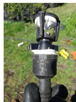
Figura 100. Detalle boquilla utilizada
