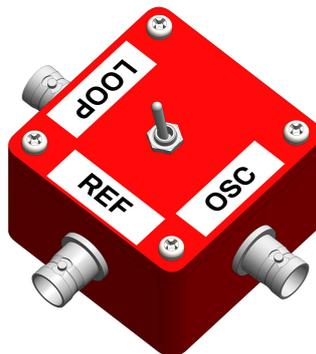
**Figura 31:** Modelo 3D del *switch* que se implemento
