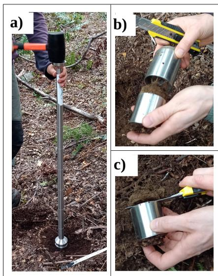
*Nota.* a) Muestreo en campo con *barreno para muestras de densidad aparente* de Copains S.R.L.
