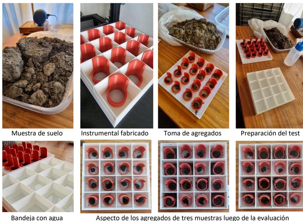
Figura 7: Muestras, instrumental, procedimiento y resultados del slake test
