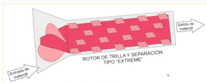
Fig 11. Sistema de trilla axial.\_
