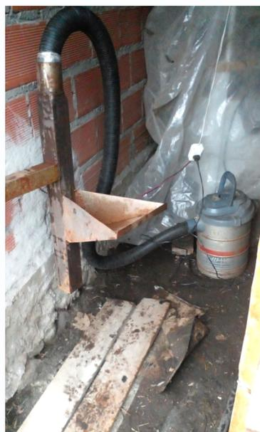
Foto 19. Sistema de limpieza mediante aspiradora adaptada.
