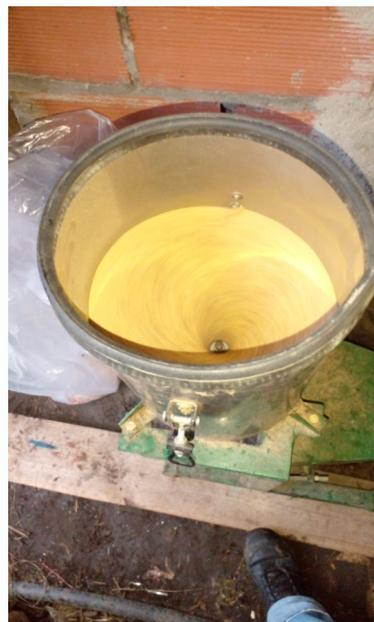
Foto 17. Centrifugado y escarificado mediante fricción.
