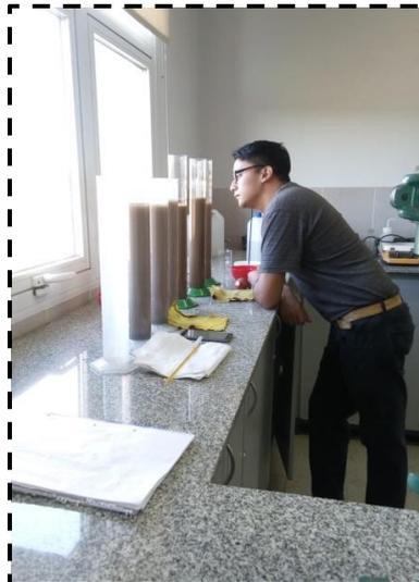
Figura 6. Determinación de la composición granulométrica en suelo.
