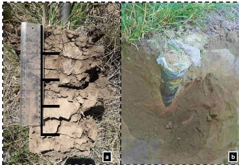
Figura 4. Muestras de suelo: a) Muestra compuesta y b) Muestra sin disturbar.
