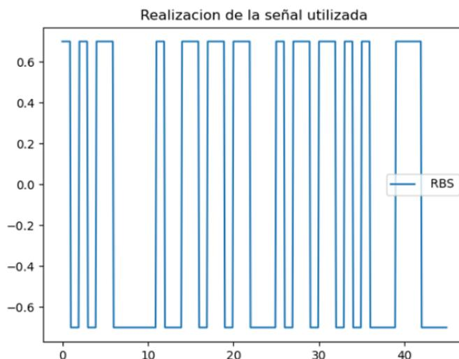
Figura 41: Señal de tipo RBS utilizada
