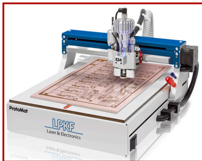
Fig. 32: CNC LPKF PhotoMat E34.
