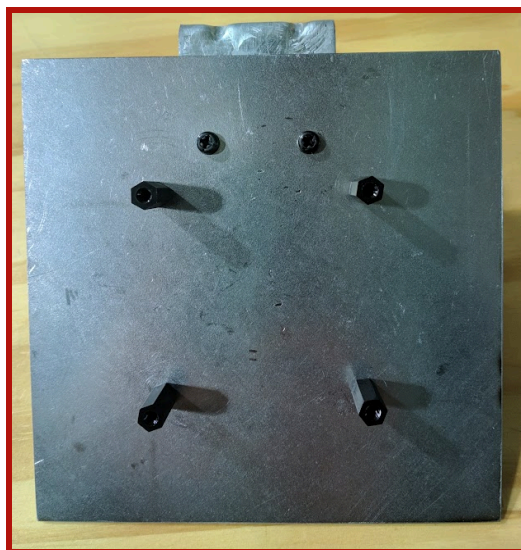
Fig. 37: Cara trasera del prototipo construido (reflector y soportes).
