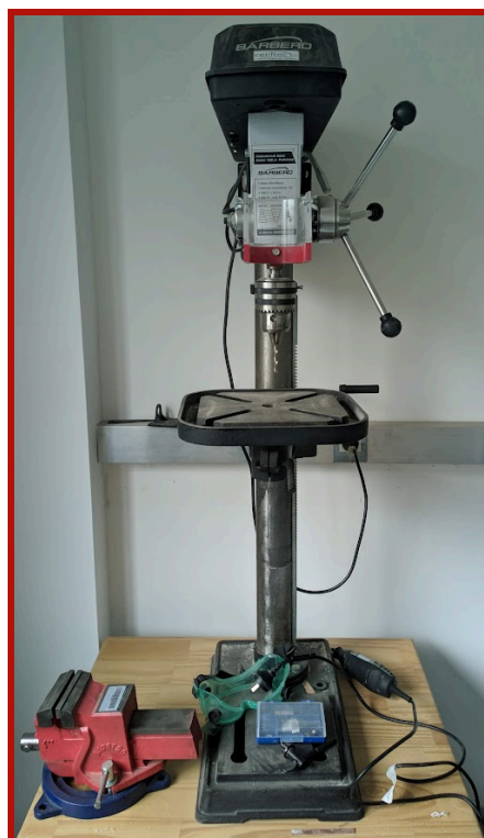
Fig. 36: Drill utilizado para la perforación del reflector.
