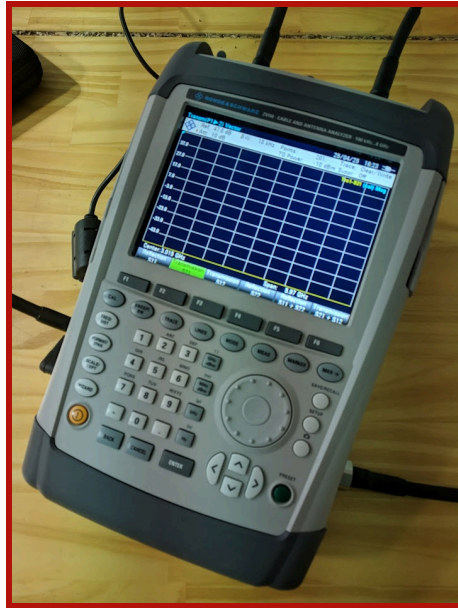
Fig. 41: Analizador vectorial de redes utilizado para obtener los parámetros S del prototipo.
