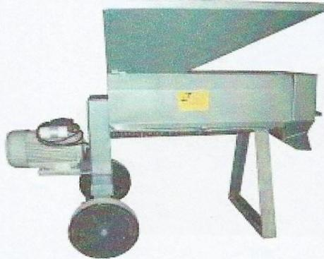
Foto 15: Peladora mecánica. Fuente: argentino.com.ar
