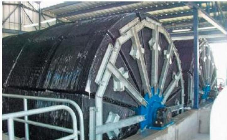
**Figura 2.7. Biodisco o Contactor Biológico Rotativo (RCB). [Armando Marín Ocampo, Manuel Osés Pérez, 2013]**
