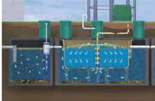
**Figura 2. Vista esquemática del funcionamiento de la planta compacta**
