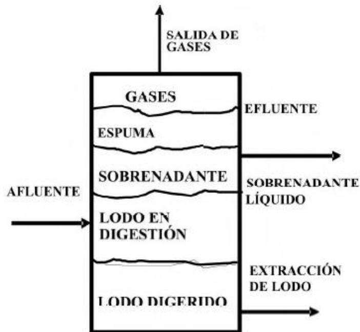
Figura 2.12. Esquema Básico de un Digestor Anaeróbico. [Menéndez Gutiérrez Carlos, Pérez Olmo Jesús M. 2007]
