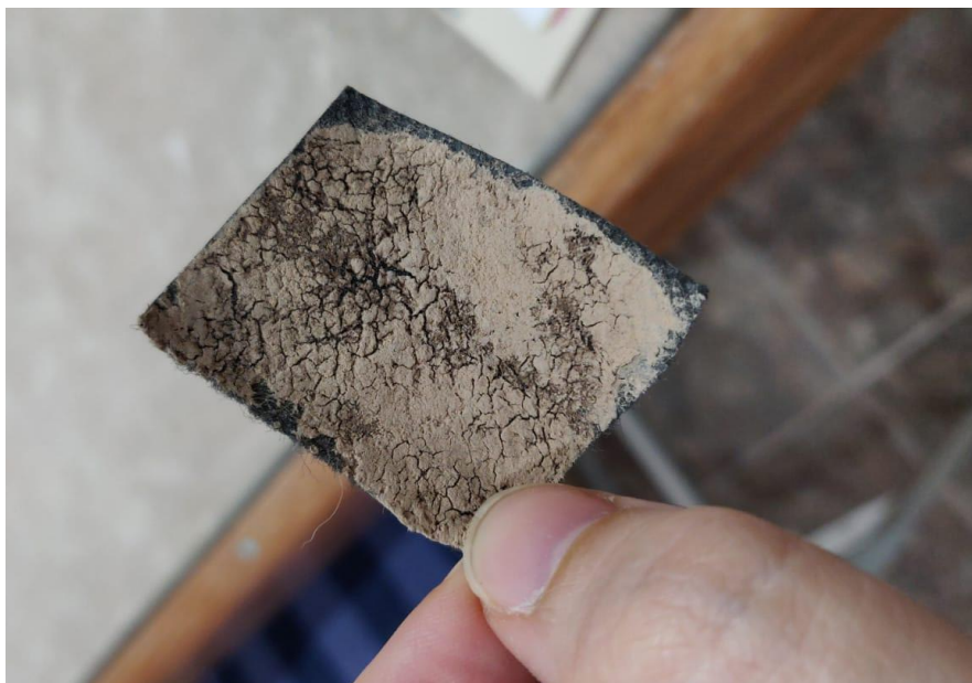
detalle de la textura de la tela no tejida cubierta de arcilla
