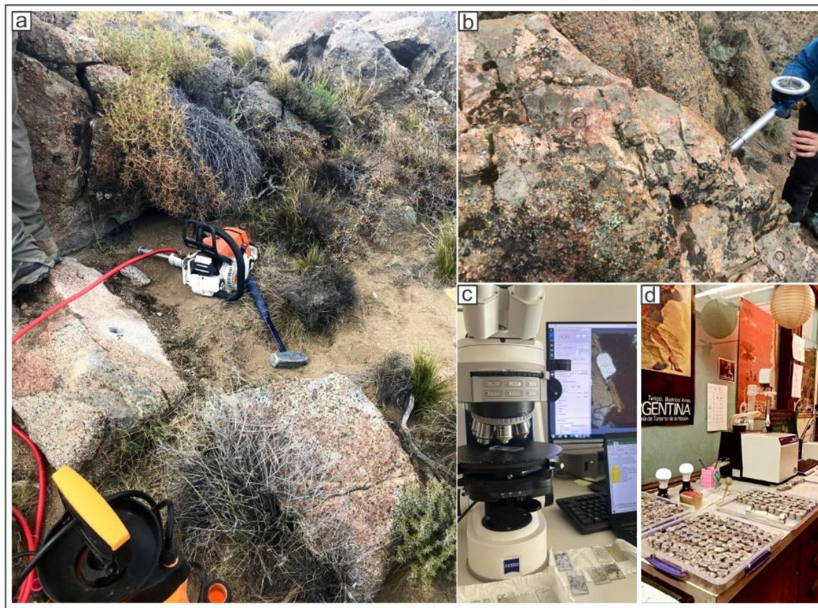
Figura 3. Trabajo de campo y de laboratorio durante la aplicación del método de ASM : a) Perforadora portátil y bidón de agua conectado a la misma mediante una manguera; b) Orientación de un cilindro de ASM in situ mediante un orientador que consta de una brújula magnética y una brújula solar; c) Microscopio petrográfico utilizado para clasificación modal y análisis de microestructuras en los cortes delgados realizados a partir de las rocas estudiadas por ASM; d) Colección de cilindros medidos en el susceptibilímetro Kappabridge MFK-1A del laboratorio del IGeBA.
