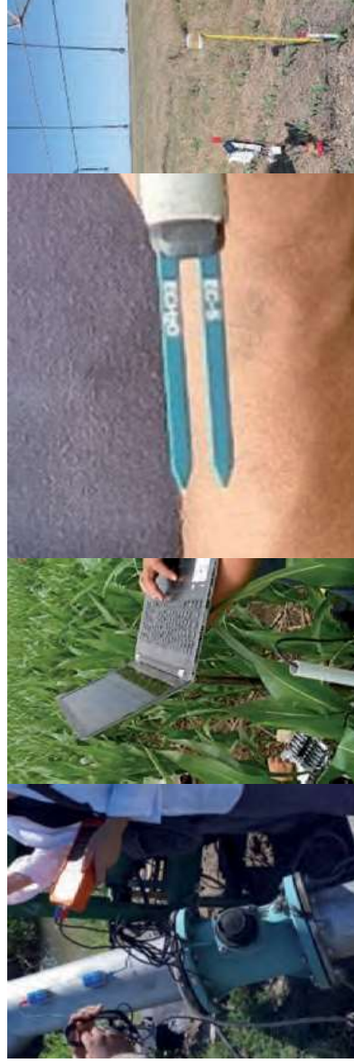
Figura 5. Instrumental de monitoreo de los componentes de riego. Mediciones de caudal del equipo, registro de los datos, y sensores de medición del contenido de agua en el suelo a diferentes profundidades.
