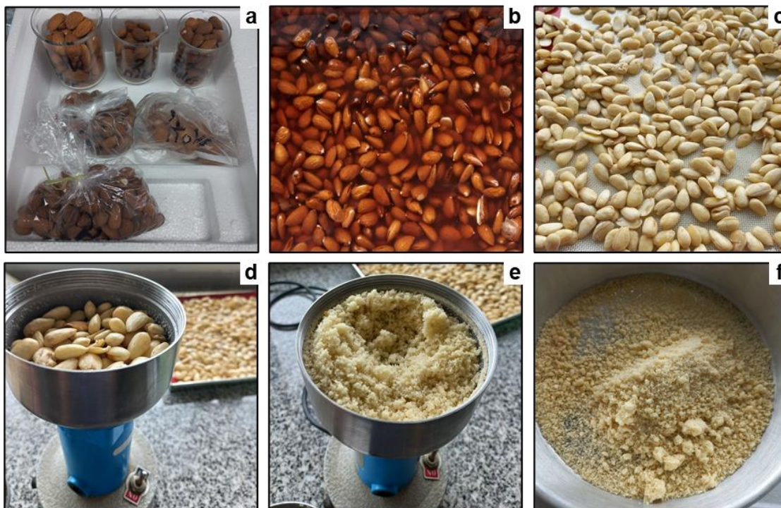
Figura 2: Etapas del proceso de obtención del polvo de almendras
