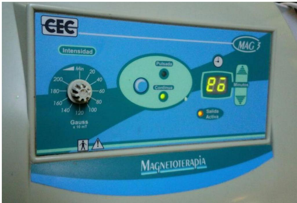
**Figura 10.** Equipo de magnetoterapia. A a izquierda se observa el regulador de intensidad (Gauss); en el centro el indicador de frecuencia; y a la derecha el reloj para la programación del tiempo que dura la emisión del campo magnético. (Cortesía de Maitén Paez, Estudiante avanzada de Medicina Veterinaria, UNRN. Imagen tomada durante su pasantía en Centro de Rehabilitación Hospital Equino “Kawell”).
