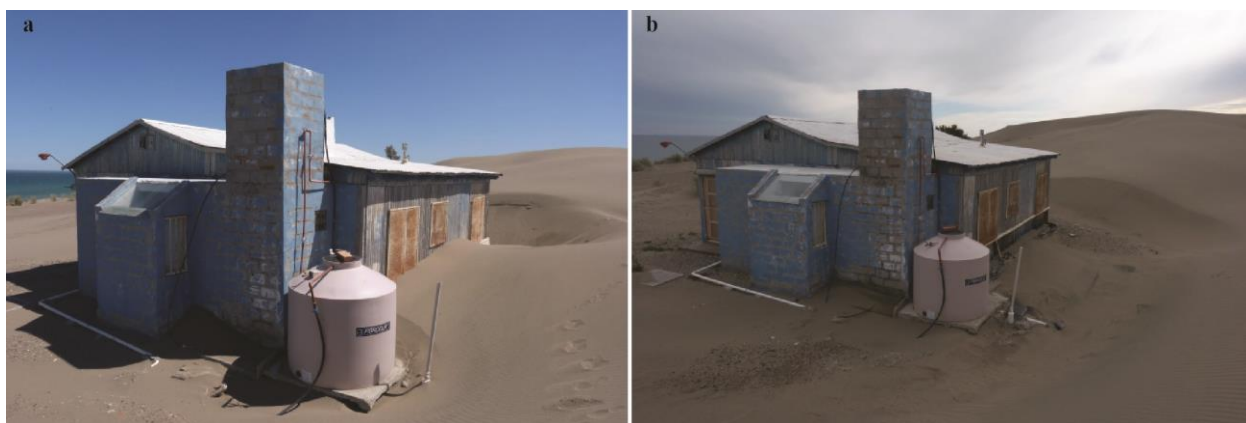
Figura 7.22. fotografías tomadas en octubre de 2016 (a) y mayo de 2017 (b) apuntando hacia el sudoeste. En este caso se observa una mayor acumulación de arena en octubre de 2016 (a), esto probablemente se deba a que realizaron una limpieza en la temporada de veraneo. De todas formas se aprecia que la acumulación de arena sigue el mismo patrón y es hacia el sur y hacia el este, como se puede observar mejor en la figura 7.27, donde no hay arena al lado de la casa.
