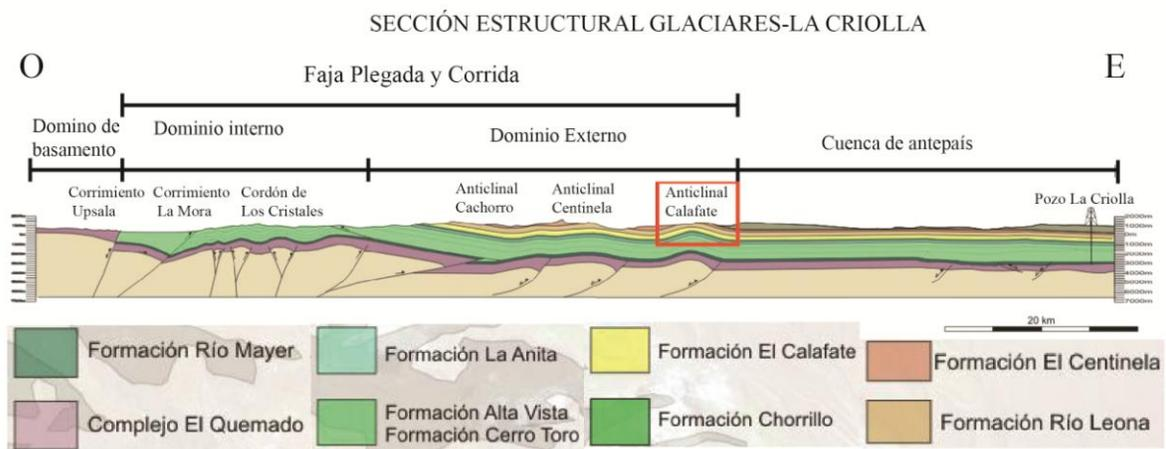
**Figura 1.2** Corte estructural correspondiente a la latitud de la zona de estudio (recuadro en rojo), en el que se interpreta un modelo de inversión tectónica para el sector interno de la faja plegada y corrida. Tomado de Pizzio (2009).
